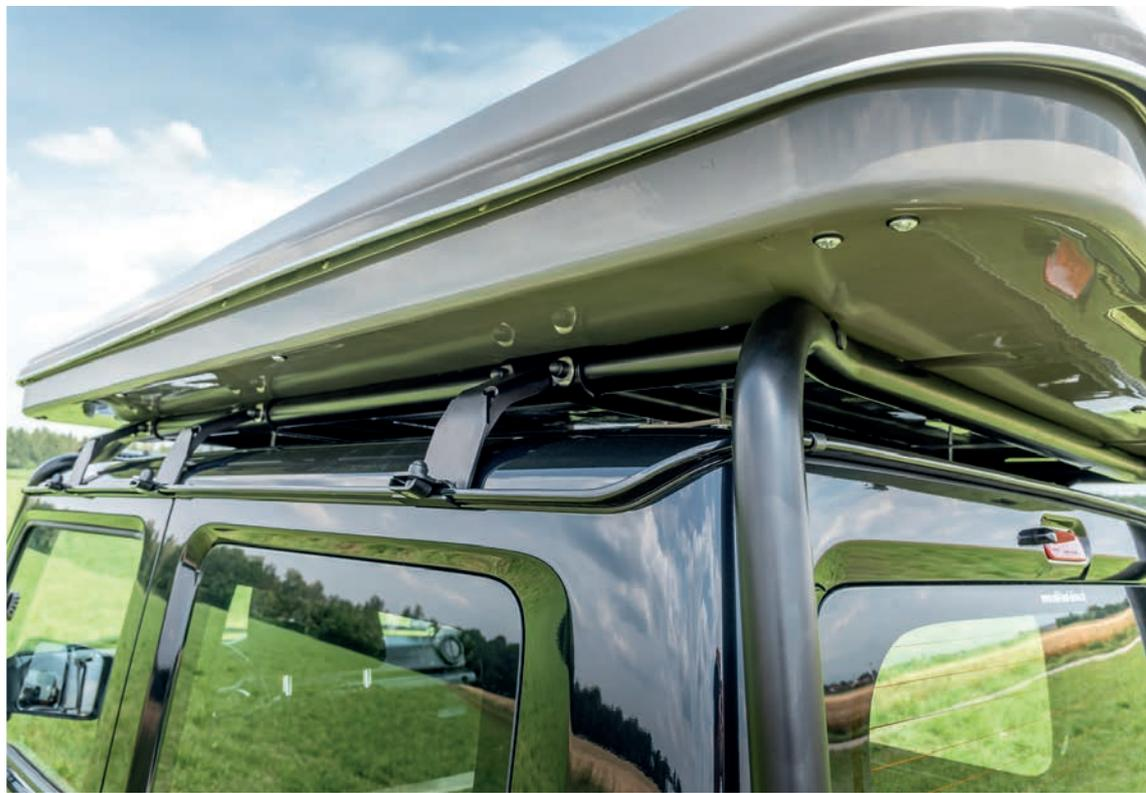
**Praktisch und stabil:** Die beiden massiven Stahlrohre des Dachträgers sind verbunden und bieten offiziell 85 Kilogramm Dachlast.
