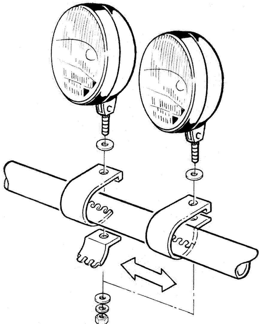
Normteile für : Ø 42, Ø51, Ø60, Ø70, Ø76
