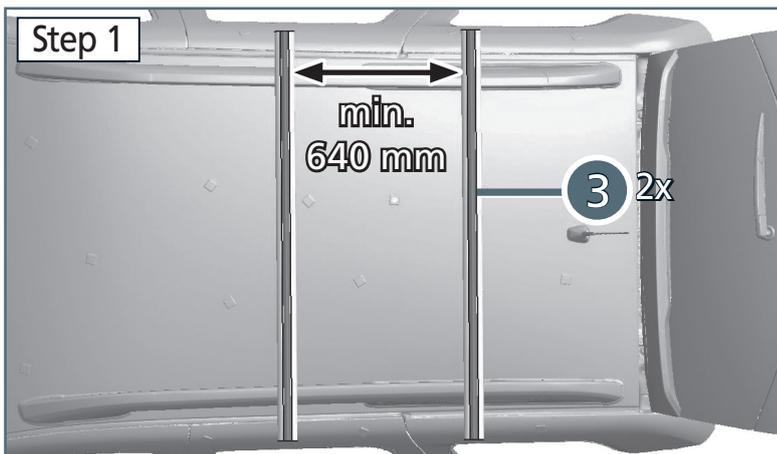
**Bei Positionierung der Dachträger darauf achten, dass die Heckklappe bei montiertem Jagdbock noch geöffnet werden kann!**
